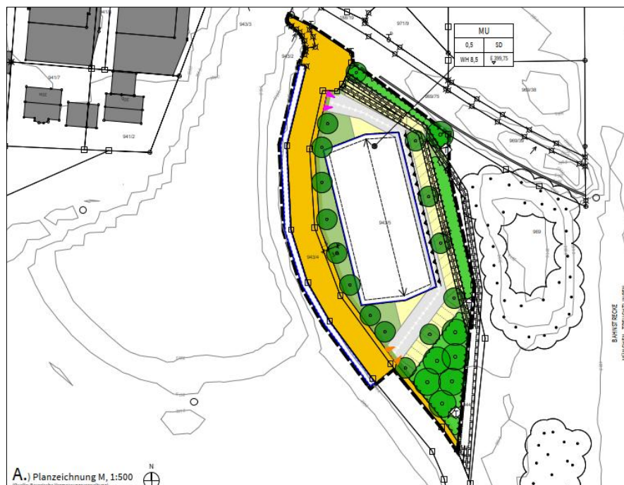
Abb. 3: Ermittlung der befestigten Flächen
