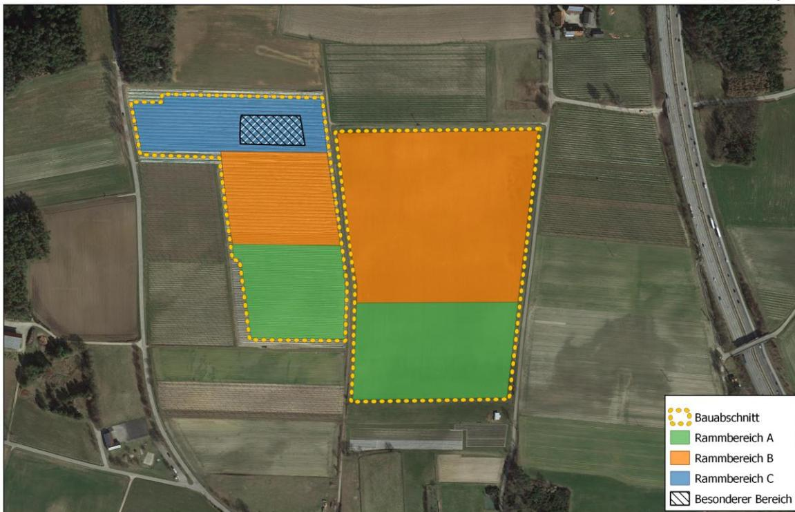
**Fazit:** Für den geplanten Baugrund empfehlen wir nach Umrechnung der Probelastungen (Rammversuche) auf das in der Statik geplante Rammfundament im Rambbereich A eine Mindesteinbindetiefe von 2,0 m (vorne, W182) und 2,0 m (hinten, W182), für den Rambbereich B eine Mindesteinbindetiefe von 2,4 m (vorne, W182) und 2,4 m (hinten, W182), sowie für den Rambbereich C eine Mindesteinbindetiefe von 2,0 m (vorne, PVC) und 2,2 m (hinten, PVC) um ausreichende Sicherheit für die berechneten Zugkräfte
