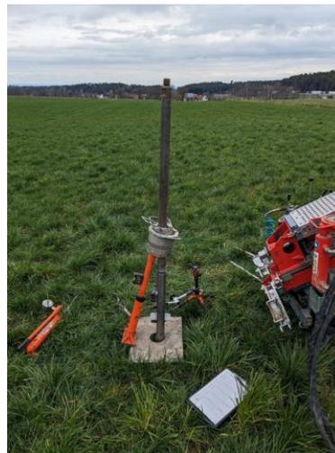
**Foto 2:** Durchführung des Schrägzugversuchs: Durch den Kolbenhub des orangenen Hydraulikzylinders wird eine Belastung unter Windsog in dem
